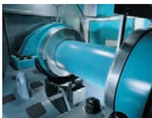
Eje del rotor: unas concepciones de rodamientos probadas y potentes
